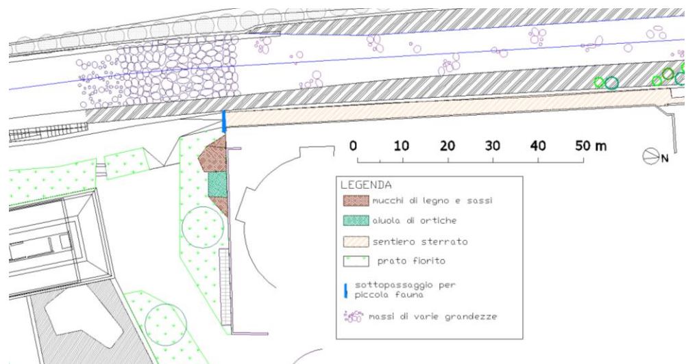
Mappa 47: Mappa con il sottopassaggio per piccola fauna e mucchi di legna e sassi per il Riccio europeo e altri piccoli vertebrati (Fonte: Adele Galli)
